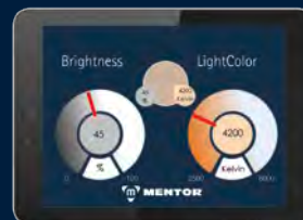
App zur Steuerung von Farbtemperatur und Helligkeit App for controlling colour temperature and brightness
